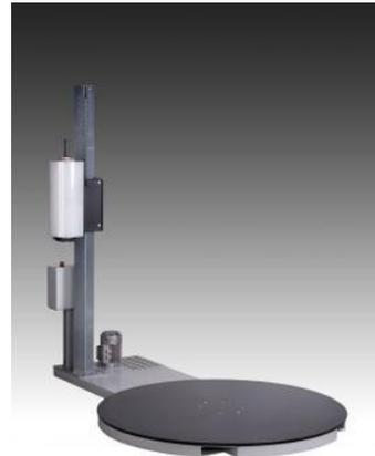
Für Betriebe mit wenig Palettenaufkommen geeignet. Die Maschine besteht aus dem angetriebenen Drehteller und dem Mast mit Folien-Handwagen. Dieser ist mit einer Handbremse für die Folienspannung ausgestattet. Ein Gegengewicht sorgt für leichtes Arbeiten.
